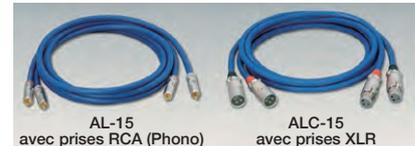
• Type : câble blindé 2 conducteurs • Conducteurs centraux : [câble en cuivre désoxygéné + câble en cuivre plaqué argent] • Gaine : PVC bleu, diamètre 8,0 mm • Diélectrique : polyéthylène + polyéthylène moulé externe • Résistance CC en boucle totale : 33 milliohms/m • Capacité entre électrodes : 170 pF/m • Résistance isolation : 40 Mohms/km
